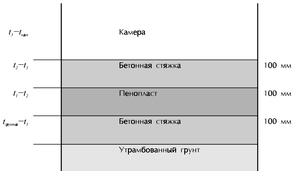
Рис. 2. Поперечный разрез пола камеры
