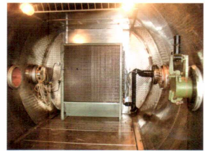
Рис. 4. Воздухоохладитель (нижняя ветвь каскада) внутри камеры
